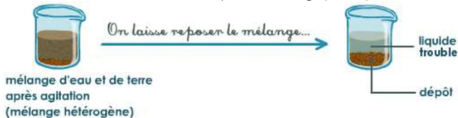
Doc. 1. Principe de la décantation.
